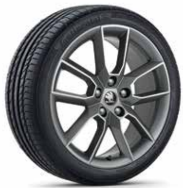
Gemini 5E0 071 498E HA7 Kolo z lehké slitiny 7,5J × 18" ET51 pro pneumatiky s rozměry 225/40 R18, v antracitové metalické barvě, broušené ŠKODA Originální příslušenství
