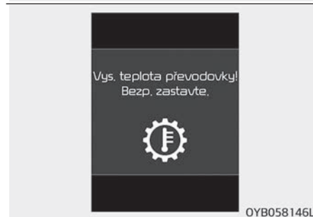
Vysoká teplota převodovky
