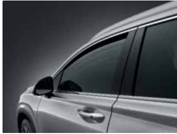
Elektrické boční okno s bezpečnostní funkcí proti přivření
