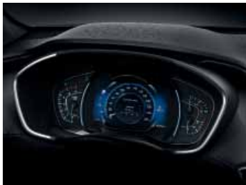
7" TFT LCD displej na přístrojovém panelu
