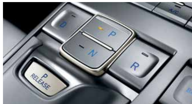
Elektronické řízení bez mechanické vazby s převodovkou
