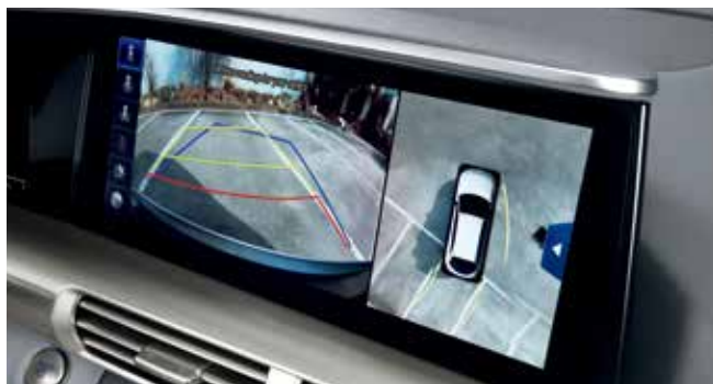
Monitorování okolí vozu 360° kamerovým systémem SVM
