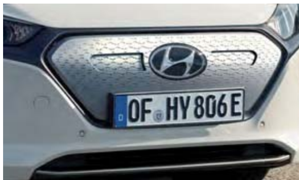
Aktivní vzduchové klapky v masce chladiče se otevírají a zavírají automaticky pro snížení odporu vzduchu.
